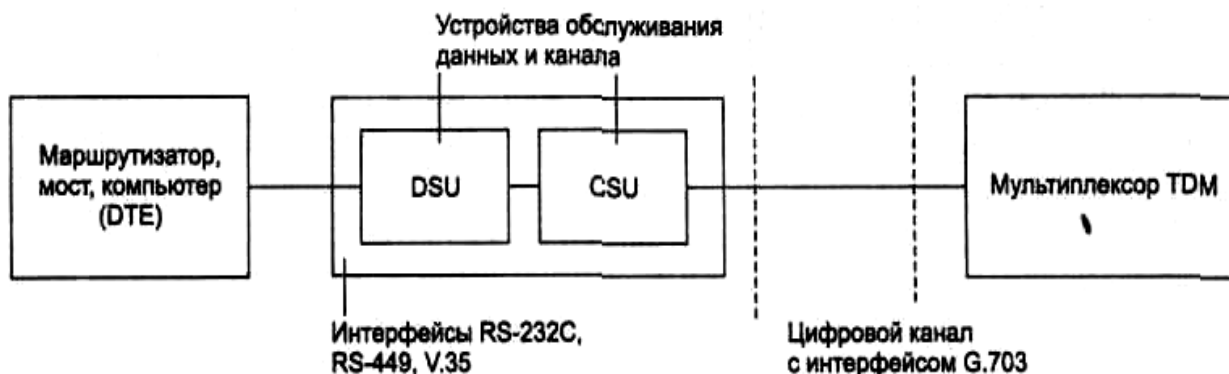
Рис. 7.2. Использование DSU/CSU для подключения к цифровой выделенной линии
